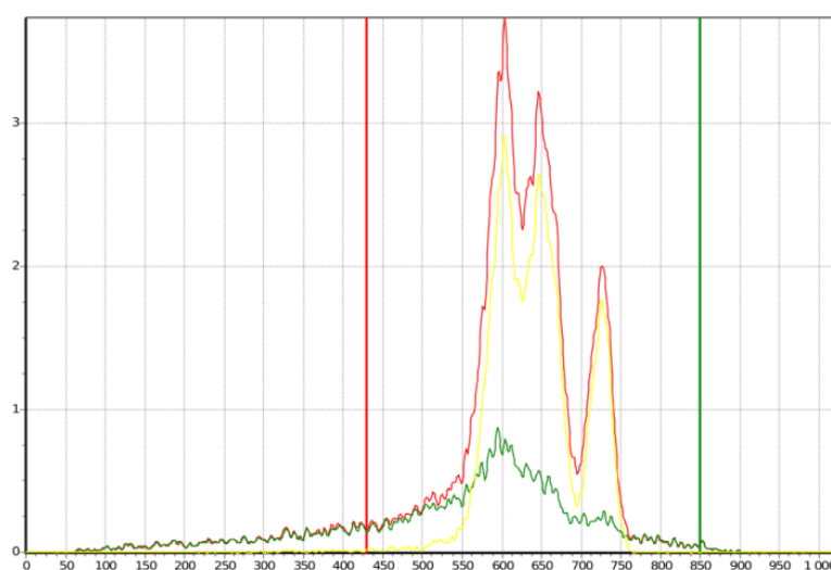
Slika 7.12 Alfa/beta separacija za standard ^{226}\text{Ra} meren na tečnom scintilacionom detektoru Quantulus - crvena linija označava alfa + beta spektar, žuta – alfa spektar, zelena – beta spektar.
