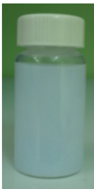
Slika 7.4 Uzorak vode pomešan sa scintilacionim koktelom koji se meša sa vodom – monofazni uzorak, u konkretnom primeru korišćen je scintilacioni koktel Ultima Gold AB.
