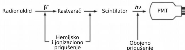
Slika 1.17 Ilustracija osnovnog procesa u tečnom scintilatoru.
